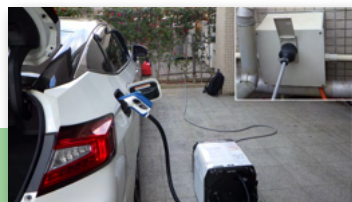
電動車から建物に電気を供給
