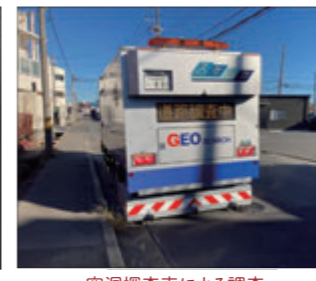
空洞探査車による調査
